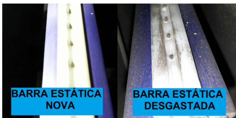
FIGURA 8 – COMPARATIVO DO DESGASTE DO ELETRODO DAS BARRAS ESTÁTICAS FONTE: OS AUTORES, 2014
