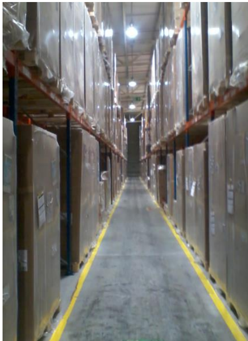
FIGURA 03: MÉTODO DE ARMAZENAGEM COM RACKS PUSHBACK. FONTE: OS AUTORES (2014).
