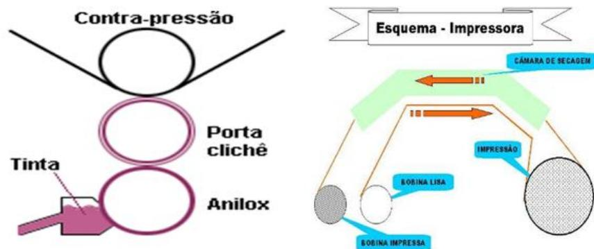
FIGURA 1 - ESQUEMA DE IMPRESSÃO FLEXOGRÁFICA
