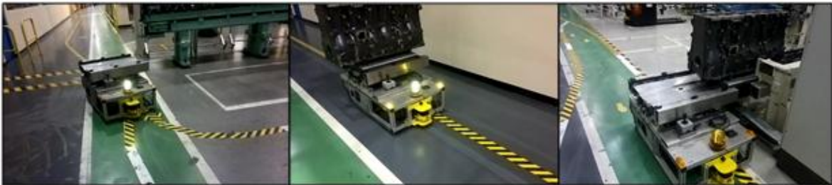
FIGURA 5: EQUIPAMENTO AGC FONTE: OS AUTORES (2013)
