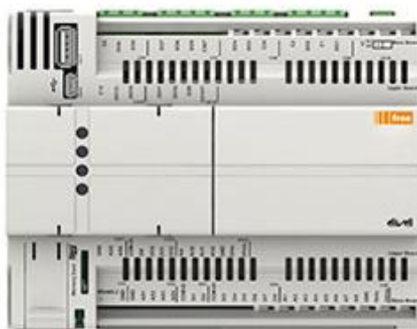
FIGURA 1 – CLP DA MARCA ELIWELL FONTE: ELIWELL (2019).
