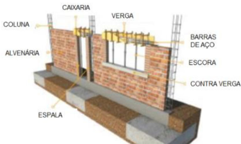
FIGURA 1- ALVENARIA DE VEDAÇÃO BLOCO CERÂMICO
