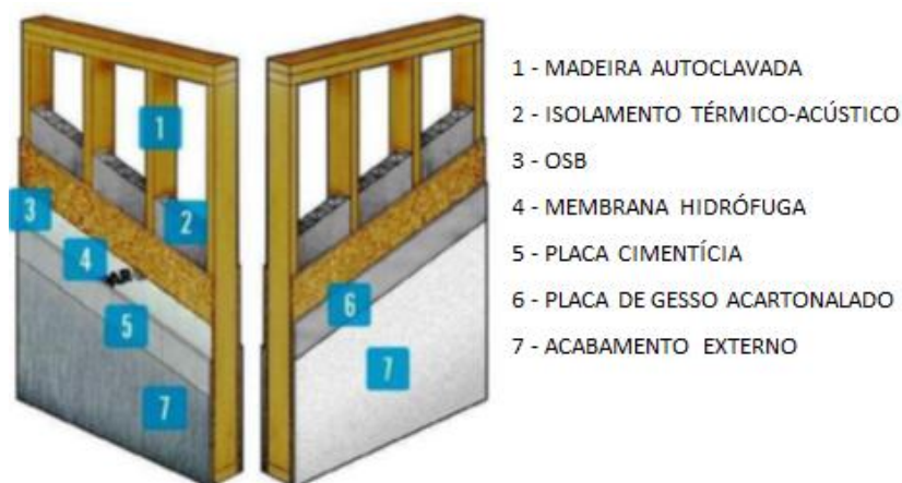
FIGURA 3 - MODELO DE PAINEL ESTRUTURAL DO TIPO PAREDE.
