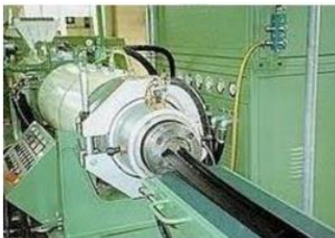
FIGURA 1: MÁQUINA EXTRUSORA DE BORRACHA UTILIZADA DE FABRICAÇÃO DE PNEU. FONTE: LEWTHWAITE (2015)
