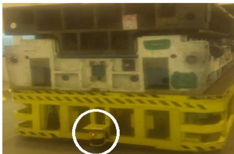
FIGURA 15: SENSOR ÓPTICO PARA SEGURANÇA INSTALADO NO VEÍCULO FONTE: Autor (2017).
