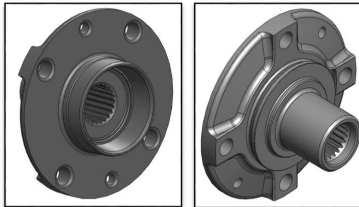
FIGURA 1 – PERSPECTIVAS FRONTAL E TRASEIRA DE CUBO DE RODA
