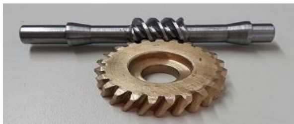
FIGURA 6: COROA E PARAFUSO SEM-FIM PROJETADO PELA EQUIPE FONTE: OS AUTORES (2018)
