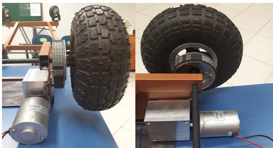
FIGURA 11: CORTADOR DE GRAMA COM OS DOIS SISTEMAS DE TRANSMISSÃO FONTE: OS AUTORES (2018)
