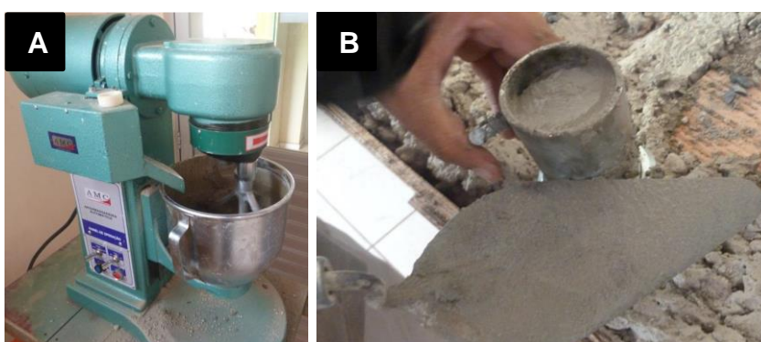
FIGURA 5: A) PREPARO DA ARGAMASSA NA ARGAMASSEIRA; B) ENCHIMENTO DOS CORPOS DE PROVA.
