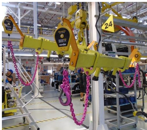
FIGURA 6: DISPOSITIVO DE PEGA DO MOTOR COM CORRENTES SUSPENSAS POR BALANCINS FONTE: AUTORES (2018)
