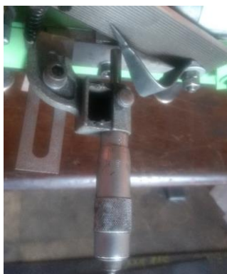
FIGURA 11: AJUSTE DE MEDIDA DA SOLDA PRATA FONTE: (AUTORES, 2018)
