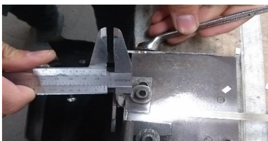
FIGURA 10: AJUSTE DE MEDIDA DA SOLDA PRATA NA GUILHOTINA MANUAL FONTE: (AUTORES, 2018)
