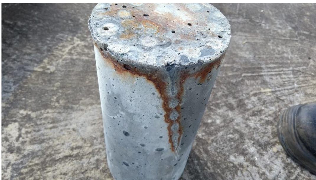
FIGURA 7: Indícios visuais do mecanismo degradante nos corpos de prova sujeitos a condição agressiva.
