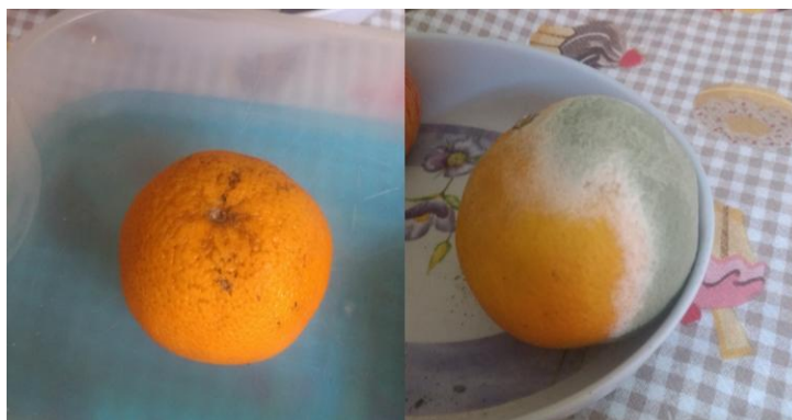
FIGURA 6 - COMPARATIVO DA LARANJA COM E SEM ADIÇÃO DO REVESTIMENTO, RESPECTIVAMENTE, APÓS DUAS SEMANAS.
