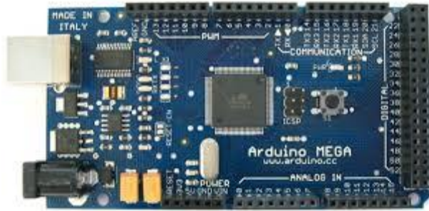
FIGURA 03 – PLACA DO ARDUINO MEGA FONTE: ROBOTIZANDO (2014).
